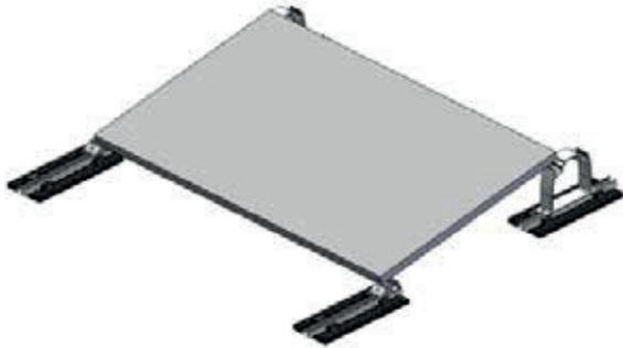
Module horizontal auf jeweils zwei Dome D1000 2.0 und zwei Dome SD 2.0 mittig auflegen. Die Stege dienen als Anschlag. Ggf. die vormontierten Dome SDs samt Bautenschutzmatte bis zum Anschlag in Richtung Modul schieben.
