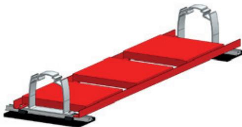
Porter (L-Winkel) auf den parallel ausgerichteten SpeedRails mit M K2 Einlegemuttern und Senkkopfschrauben befestigen.
