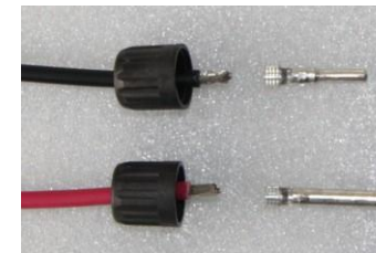
▲ Figuur 4.7 Steek de draad in de dopmoer van de connector en de contactpen
