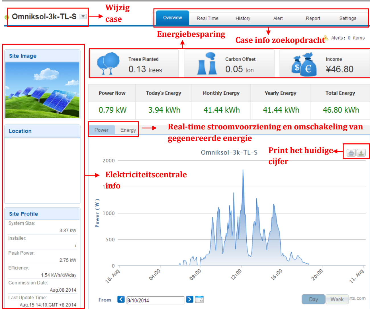
Hoofdinterface van de Electriciteitscentrale
