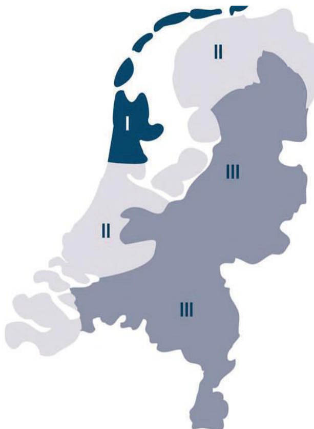
Platdak ballasttabel voor Nederland voor Maxis collector
