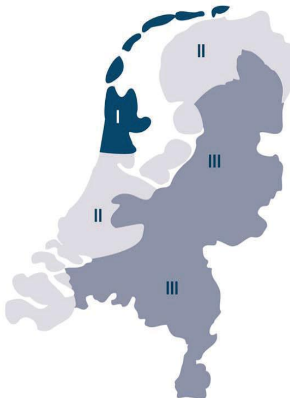
Platdak ballasttabel voor Nederland voor Nero collector
