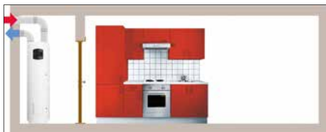
LUCHT AAN EN AFVOER VIA DE BUITENLUCHT OM DE BINNENRUIMTE NIET AF TE KOELEN (IN EEN VERWARMDE RUIMTE)
