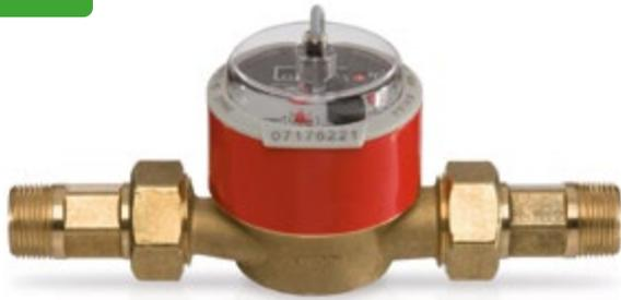
Das RESOL V40 ist ein Messgerät mit Kontaktgeber zur Erfassung des Durchflusses von Wasser oder Wasser-Glykol-Gemischen und wird in Verbindung mit RESOL-Wärmemengenzählern eingesetzt. Nach dem Durchströmen eines konkreten Volumens gibt das V40 einen Impuls an den Wärmemengenzähler ab.
