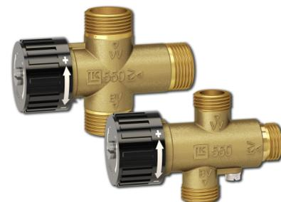
LK 550 AquaMix ist ein Mischventil für die Warmwasserbereitung mit einem thermischen Einsatz zur Regelung der Warmwassertemperatur. Mit der Installation von einem Rückschlagventil in der Kaltwasserleitung wird der Rückfluss von Warmwasser verhindert. Zur einfachen Entleerung von kleineren Warmwasserbereitern, sind Ventile mit Anschlussgröße G 1/2" Aussengewinde oder 15 mm Klemmverschraubung, mit einer Luftschraube versehen.
