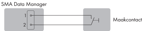
Afbeelding 8: Aansluitvoorbeeld van een schakelaar voor de snel-stop
