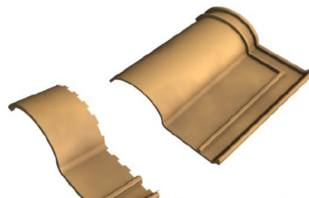
Snijden van de dakpannen thv bovenste afdekplaat
